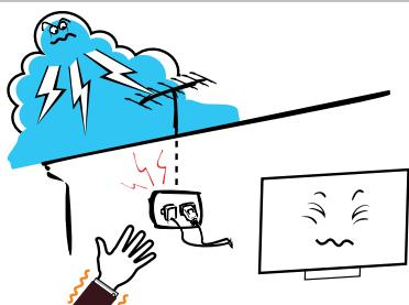
۸- از نصب آنتن در مجاورت خطوط برق فشار قوی، رعد و برق یا جریانات الکتریکی خودداری نمایید. هنگام نصب آنتن هوایی باید توجه داشته باشید که از نصب آن در چنین مکان‌هایی خودداری کنید چرا که خطرات جدی به همراه دارد. در هنگام رعد و برق دوشاخه را از پریز خارج کرده و هرگز به سیم آنتن دست نزنید. هم‌چنین توجه داشته باشید لبه‌های تلویزیون از میزی که بر روی آن قرار داده‌اید، بیرون نزده باشد.
