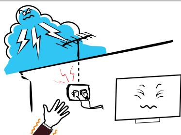
۸- از نصب آنتن در مجاورت خطوط برق فشار قوی، رعد و برق یا جریانات الکتریکی خودداری نمایید. هنگام نصب آنتن هوابی باید توجه داشته باشید که از نصب آن در چنین مکان هایی خودداری کنید چرا که خطرات جدی به همراه دارد. در هنگام رعد و برق دوشاخه را از پریز خارج کرده و هرگز به سیم آنتن دست نزنید. همچنین توجه داشته باشید لبه های تلویزیون از میزی که بر روی آن قرار داده اید، بیرون نزده باشد.
