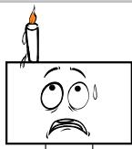
۷- جهت جلوگیری از آتشسوزی، از قرار دادن شمع بر روی تلویزیون خودداری کنید. دمای مناسب کار دستگاه از ۵ درجه سانتی گراد تا ۳۵ درجه می باشد. رطوبت مناسب کار دستگاه از ۲۰ درصد تا ۸۰ درصد می باشد. تلویزیون را در محیط های پر از گرد و خاک قرار ندهید.
