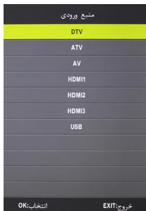
◀ دکمه SOURCE را بر روی دستگاه کنترل از راه دور برای نمایش لیست ورودی ها فشار دهید. از دکمه های جهتی بالا و پایین برای انتخاب تلویزیون یا دیگر منابع ورودی استفاده کرده سپس OK را برای تایید فشار دهید.
