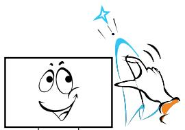
▶ برای تمیز کردن صفحه و بدنه تلویزیون، ابتدا دوشاخه را از پریز برق خارج کرده و سپس با استفاده از پارچه نرم و بدون پرز آن را تمیز نمایید. در صورت نیاز می‌توانید از یک پارچه نمدار استفاده کنید.
