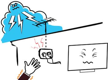
۸- از نصب آنتن در مجاورت خطوط برق فشار قوی، رعد و برق یا جریان‌های الکتریکی خودداری نمایید. هنگام نصب آنتن هوایی باید توجه داشته باشید که از نصب آن در چنین مکان‌هایی خودداری کنید چرا که خطرات جدی به همراه دارد. در هنگام رعد و برق دوشاخه را از پریز خارج کرده و هرگز به سیم آنتن دست نزنید. همچنین توجه داشته باشید لبه‌های تلویزیون از میزی که بر روی آن قرار داده‌اید، بیرون نزده باشد.
